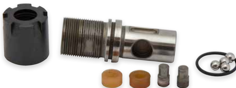
Bild 3: Spannkopf und die Spannmutter zeigen keinen Verschleiß.
